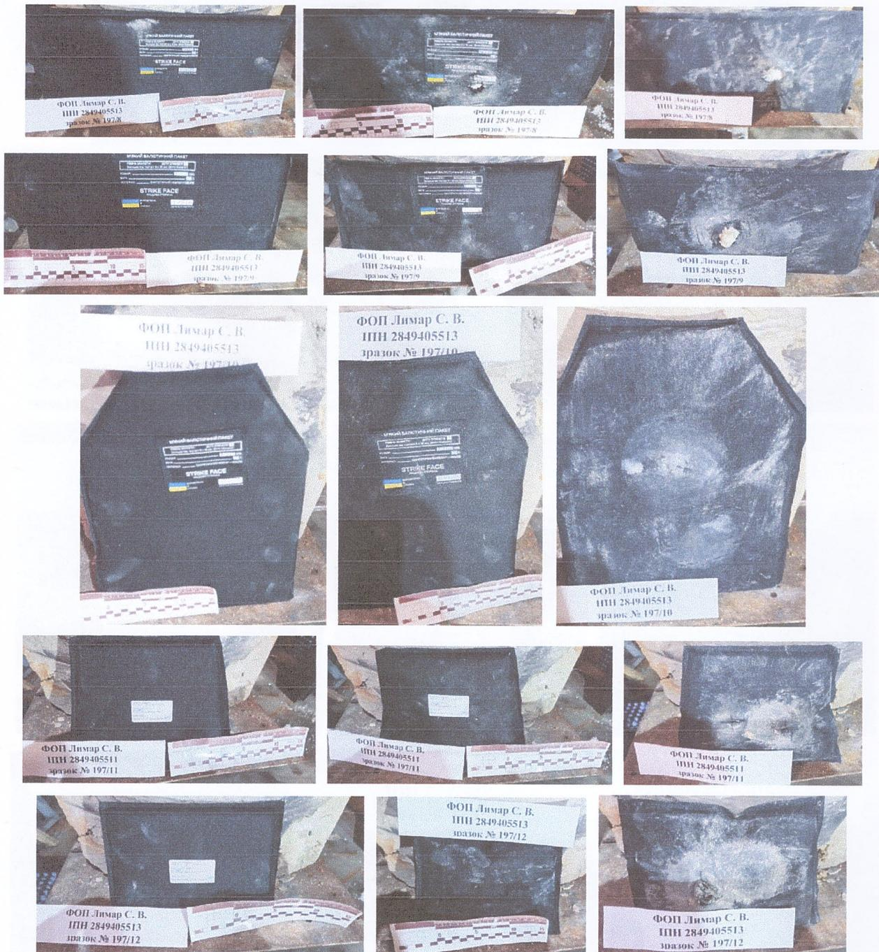
Фото 1.1.1. Зразки № 197/1 ÷ № 197/12 до та після випробування (за нормальних умов).
