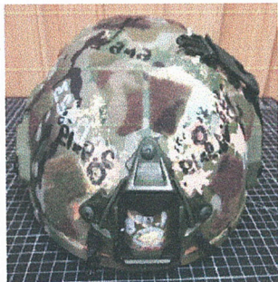
Фото 1 ( Зона лобної частини голови після випробувань)
