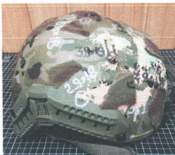
Фото 2 ( Зона правої скроневої частини голови після випробувань)
